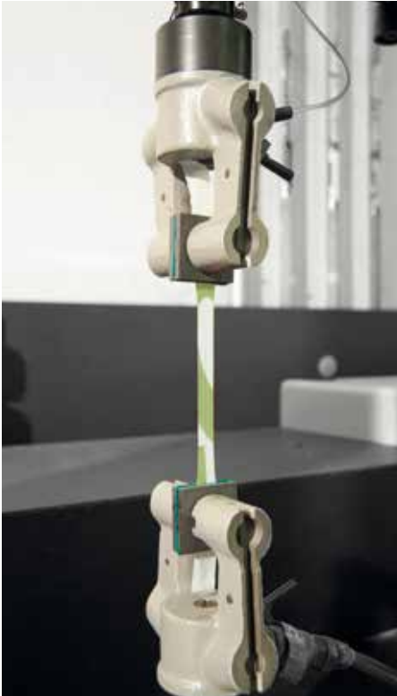
Test di resistenza del film in MATER-BI
